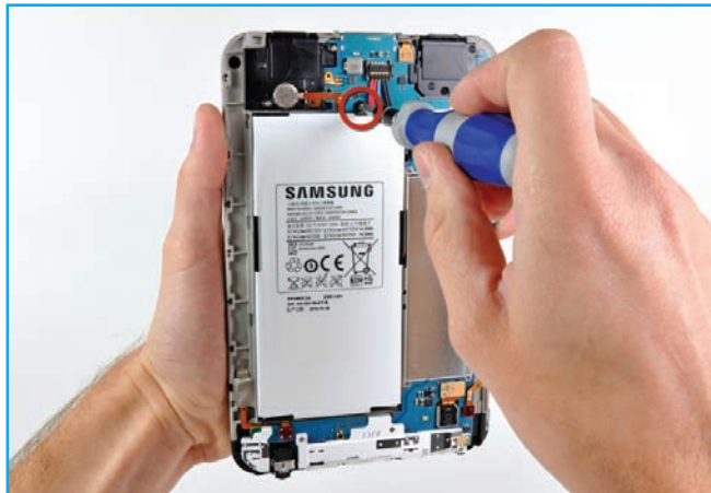
Imagen de uno de los pasos necesarios para desarmar una Tablet Galaxy Tab
