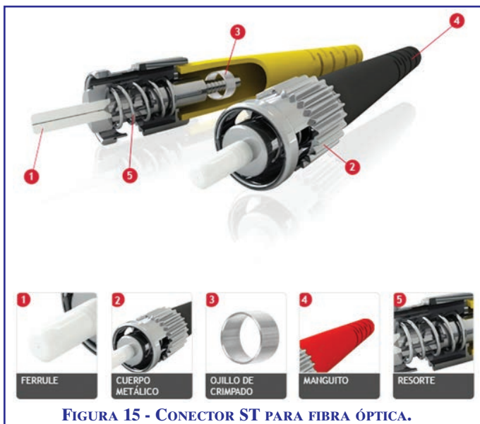
FIGURA 14 - CONECTORES PARA FIBRAS ÓPTICAS.
